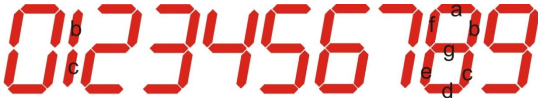
Gambar 2. Tampilan angka pada seven segment
